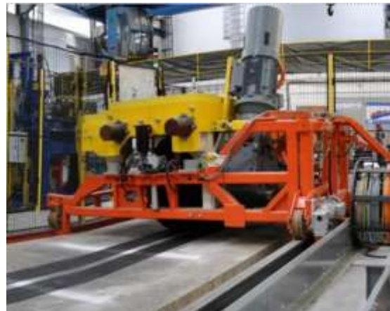
Obr. 4. Zrýchlené testovanie vozoviek
