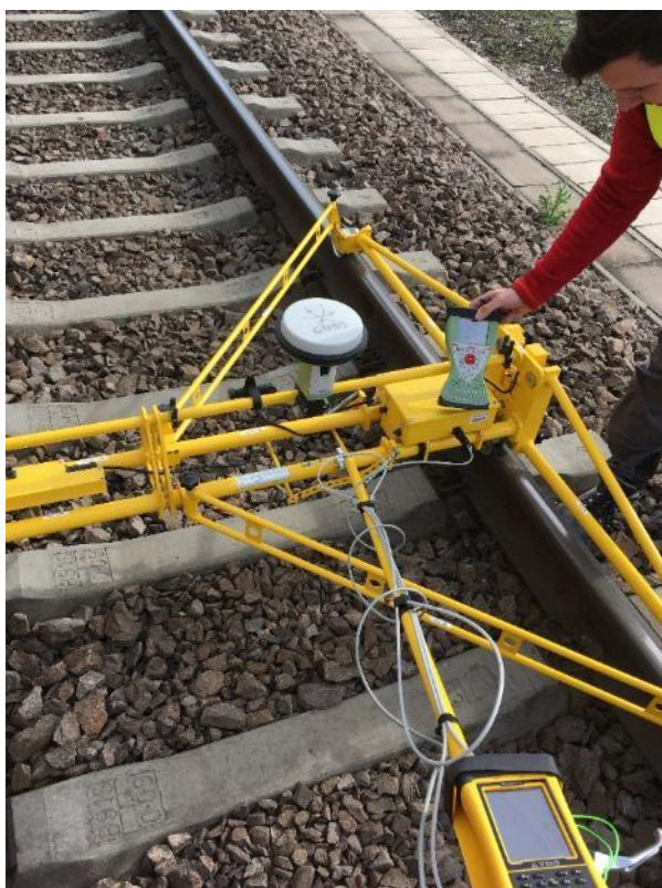
Obr. 14. Meranie geometrie koľaje
